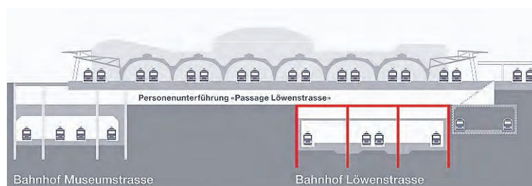
Der neue Bahnhof liegt unter den Gleisen 4–9 des HB Zürich. Rechts die neuen Passagen und Einkaufszonen (rot) und die bestehenden (blau).
