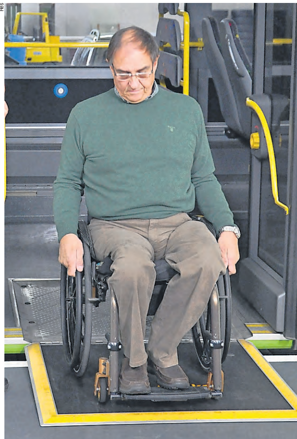
La rampe peut être installée par le chauffeur mais aussi par les usagers à l'intérieur du bus qui prennent parfois les devants.
