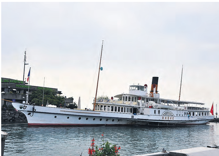
Le Rhône a été construit en 1927 par Sulzer Frères à Winterthur. Il peut transporter 850 personnes à une vitesse maximale de 27,5 km/h. C'est un bateau à vapeur à commande hydraulique (unique au monde) et à roues à aubes. C'est l'un des huit bateaux de la flotte Belle-Epoque de la CGN classée monument historique.
