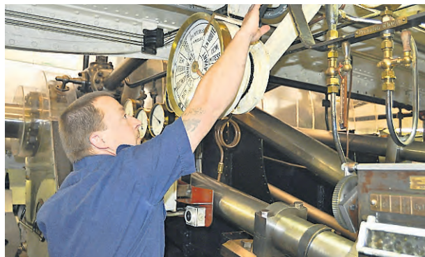
Une aiguille reliée par des câbles au Chadburn du capitaine indique à Olivier Mettraux les ordres qu'il doit exécuter.
