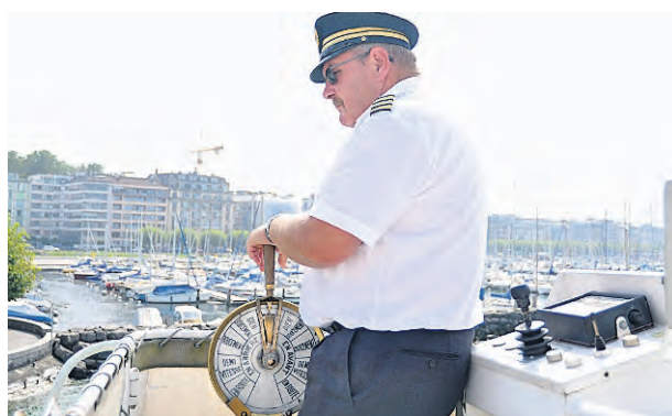
Depuis la passerelle, le capitaine Michel Bonzon transmet les ordres à son mécanicien par le truchement du Chadburn.
