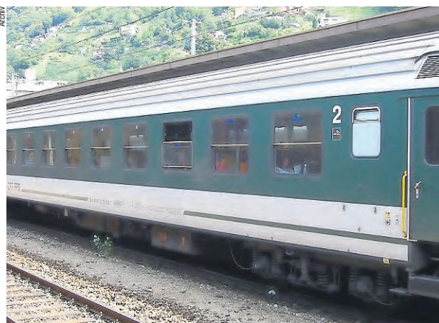
Unerwarteter Asbestfund im Februar: Wagentyp Bpm 51.
