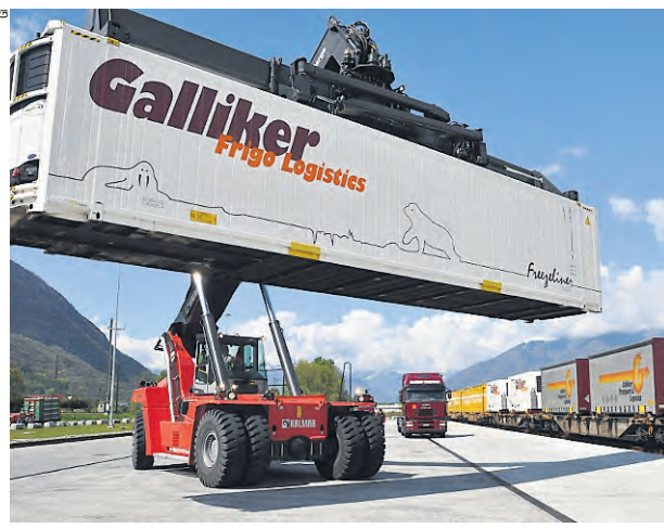
SBB Cargo hat für Cadenazzo eigens ein Fahrzeug gekauft, das Wechselbehälter und Container bis 40 Tonnen Gewicht zwischen Lkw und Bahn umladen kann.
