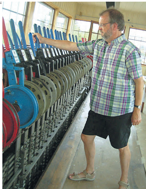
Almeno una volta al mese, bisogna azionare tutte le leve, per garantirne il funzionamento.
