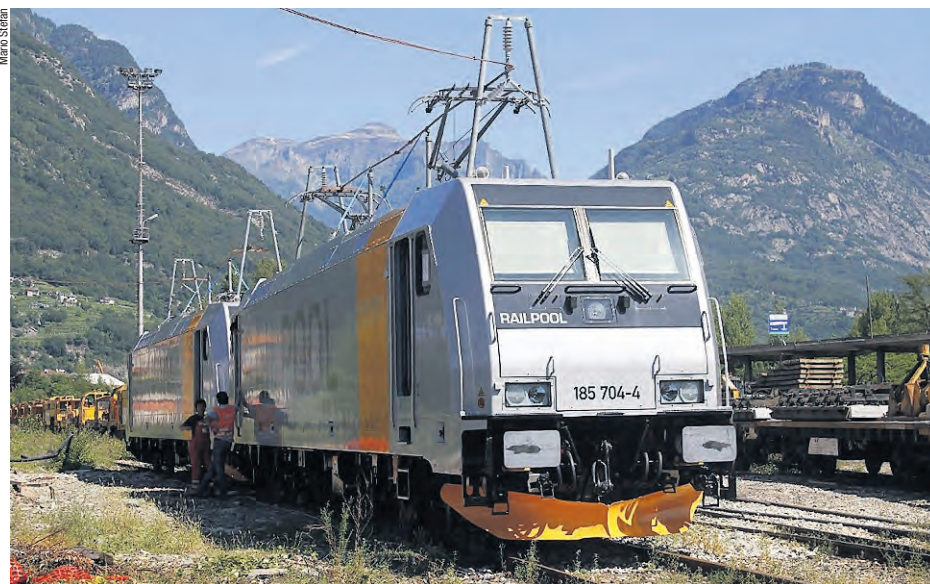
Die beiden Railpool-Lokomotiven 185 704-4 und 185 705-1 in Domodossola sind fest installiert und vorbereitet, bei einem Ausfall der beiden fahrbaren Unterwerke in Varzo Blindenergie unter 15 kV auf der Simplon-Südrampe einzuspeisen.
