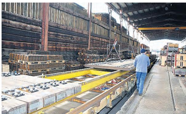
8. Départ. Les traverses terminées, pesant 110 kilos, sont prêtes à être transportées et installées sur les chantiers.
