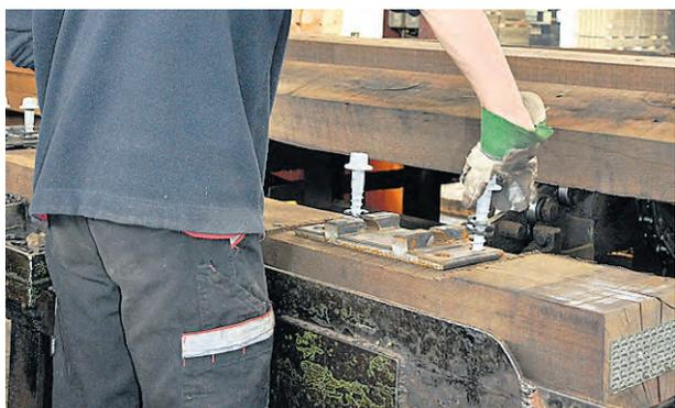
7. Mise en place du système de pièces métalliques servant à fixer les rails aux endroits où le bois a été entaillé et pré-perçé.
