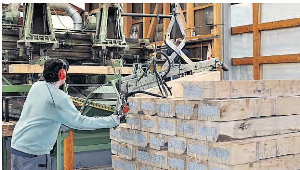
3. Une machine fixe une plaquette métallique à chaque extrémité des traverses pour éviter les fissures durant leur séchage.
