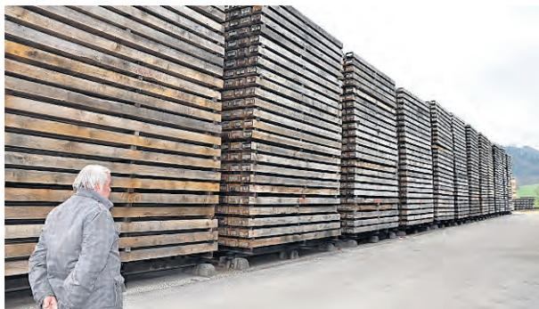
4. L'entreposage des traverses en plein air dure entre 12 et 18 mois pour le hêtre et entre 18 et 24 mois pour le chêne.
