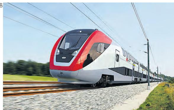
Moins d'énergie, moins d'usure des rails, et plus de vitesse dans les virages grâce à une compensation du gîte (ou du dévers) intégrée au bogie. En confiant la commande à Bombardier, les CFF ont parié sur une nouvelle technologie. En 2014, au terme de la phase d'homologation, ce sera à l'OFT de dire si le pari est gagné.
