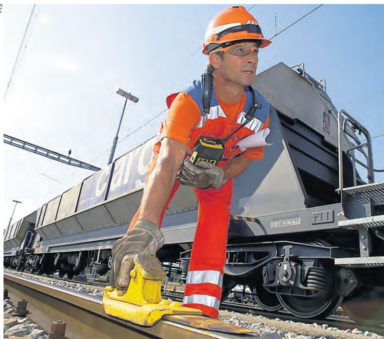
Posare stoffe d'arresto: un compito reso sempre più spesso superfluo dai freni automatici di binario che arrestano i vagoni al termine della discesa dalla sella di lancio.
