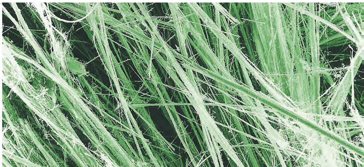
L'amianto visto al microscopio: questo minerale tossico si frammenta in minuscole fibre che provocano gravi malattie quando si respirano
