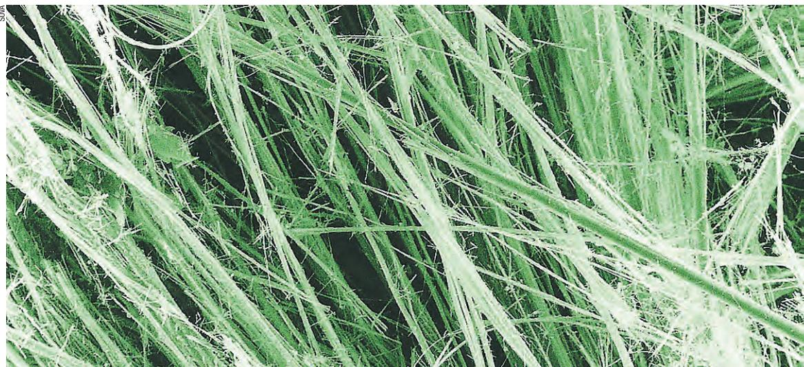
De l'amiante vu au microscope. Ce minéral toxique se fragmente en fibres minuscules qui provoquent des maladies graves si on les respire.
