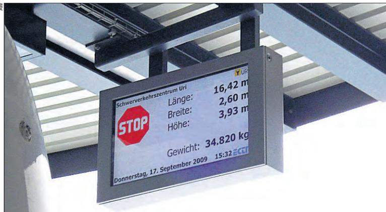
Die Daten jedes Fahrzeugs werden automatisch ermittelt und angezeigt.
