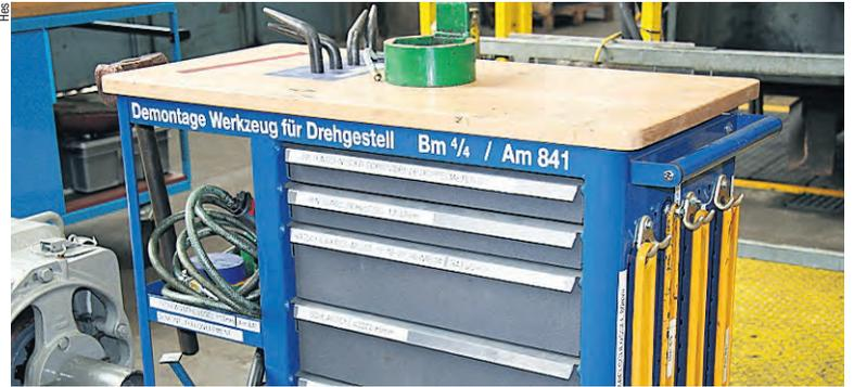
Mit dem Rollwagen an den Arbeitsplatz: Das Werkzeug ist für eine bestimmte Aufgabe sortiert.
