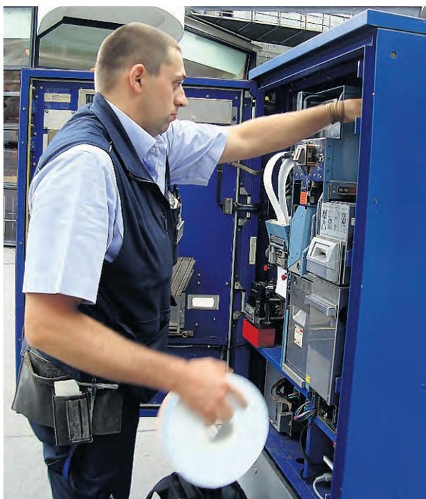
Fahrausweispapier-Rollenwechsel an einem ZV-Billettautomaten.
