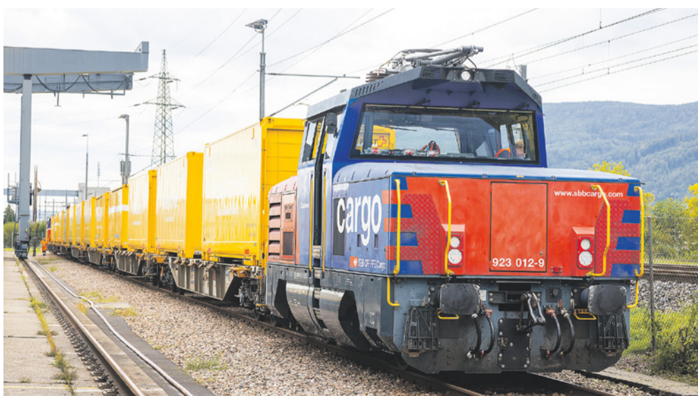
Test avec un train-navette postal fixe - avec une locomotive hybride Eem 923 en tête et en queue et des attelages automatiques - entre les centres de colis de Daillens, Härkingen et Frauenfeld.
