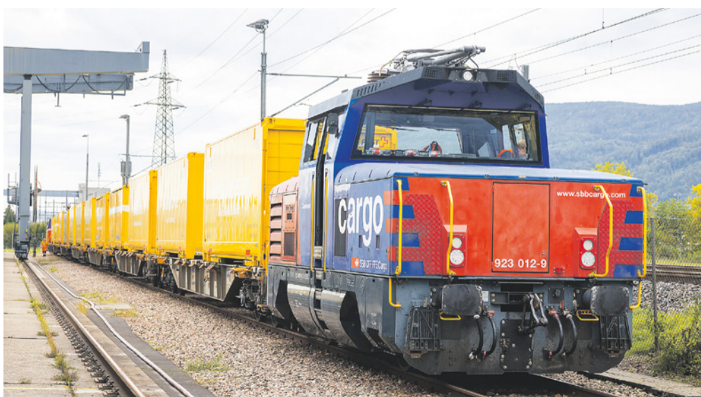
Testbetrieb mit fixem Post-Pendelzug – mit je einer Hybridlokom Eem 923 an Spitze und Ende und automatischen Kupplungen – zwischen den Paketzentren Dailens, Härkingen und Frauenfeld.
