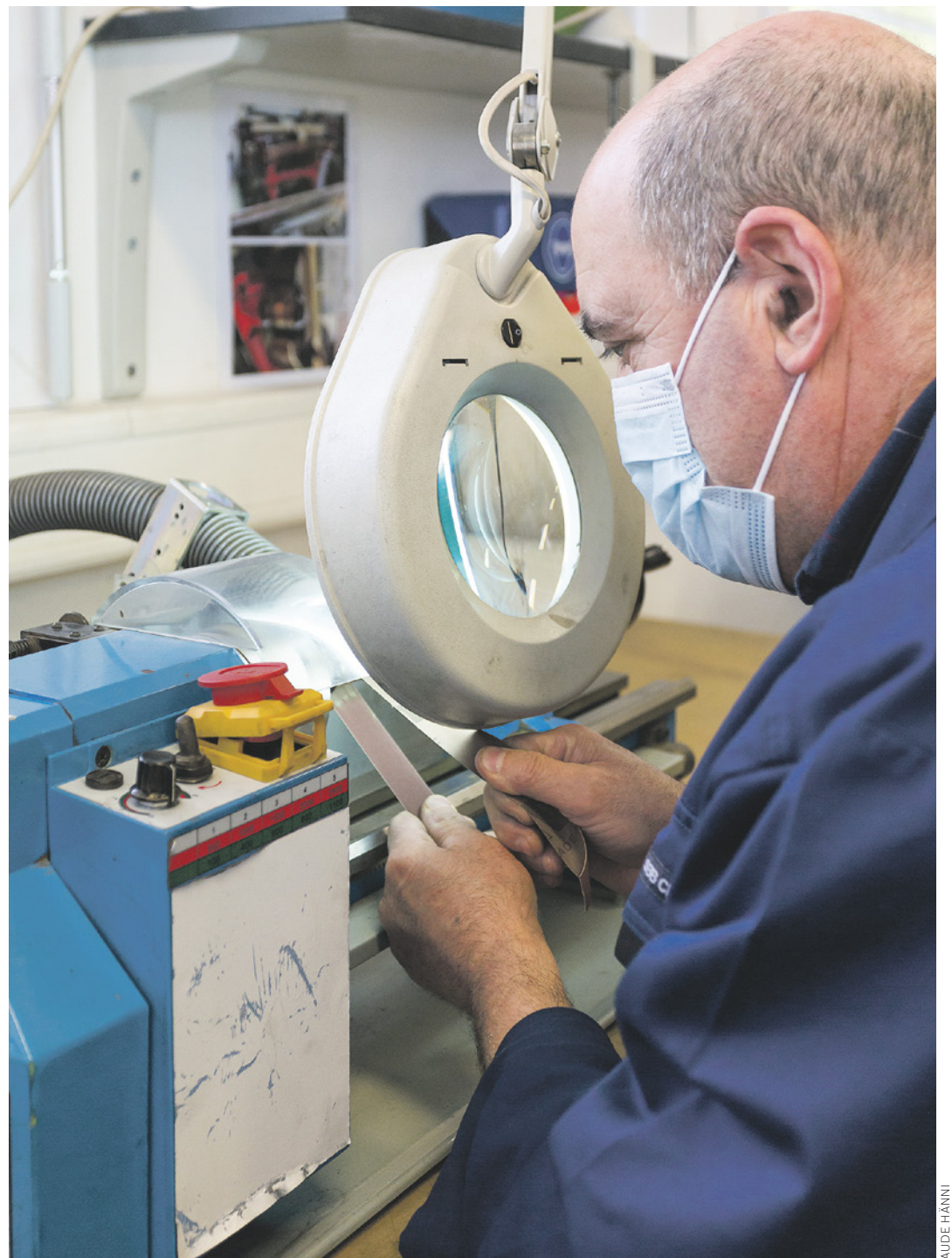
À Penthalaz, au lieu de changer les rouleaux de contact en laiton noirs et graisseux, les employés les polissent pour qu'ils perdent encore quelques années.
