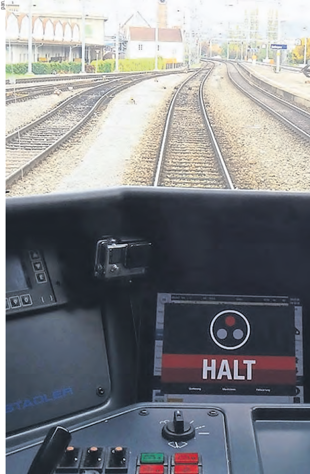
So sieht der Lokführer die Strecke. Die App (im Vordergrund) sollte nur dann «Halt» anzeigen, wenn das Signal geschlossen ist...
