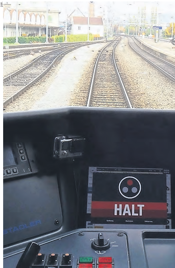
Ecco come il macchinista vede la tratta. La App (in primo piano) dovrebbe solo mostrare «Halt» quando il segnale è chiuso...
