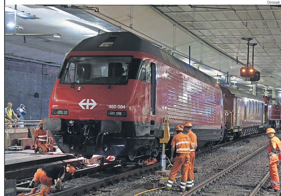
Bahnhof Bern, 18. August 2016: Die SBB Lokomotive Re 460 084-7 mit Taufname Helvetia muss infolge eines Defektes auf Hilfsdrehgestelle aufgeladen werden.
