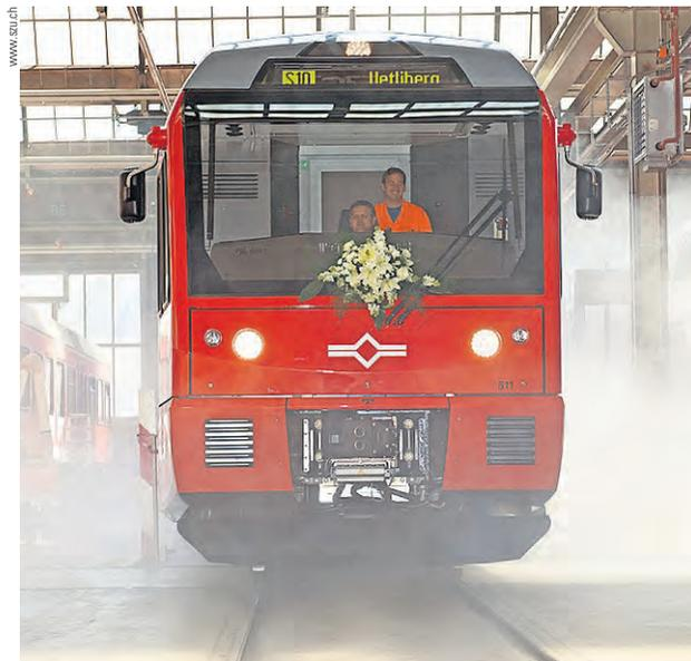
Im Juni 2013 präsentierte die SZU in ihrem Depot den ersten von sechs Stadler-Triebzügen Be510, die heute vorwiegend auf der Uetliberglinie S10 mit 1200 V Gleichstrom verkehren, aber auch auf der Sihltallinie S4 mit 15 kV Wechselspannung fahren können.
