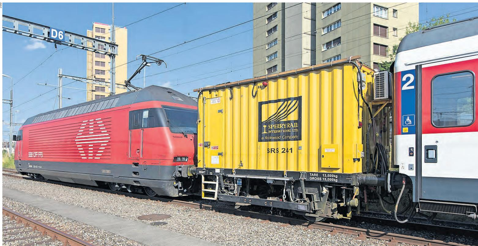
Der neue Schienenprüfwagen Sperry SRS 241, der mittels Ultraschall feinste Risse in den Schienen erkennen kann, hat zusätzlichen Unterhaltsbedarf aufgezeigt.
