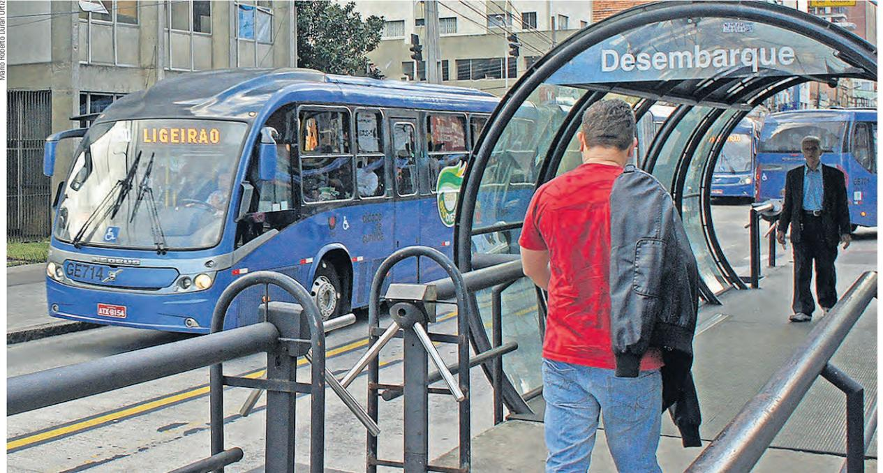
Doppelgelenkbus auf eigenem Trasse mit genau definierten Haltestellen in Curitiba.
